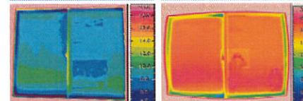
「インプラス」は樹脂製。樹脂はアルミニウムに比べて熱伝導率が1/1000程度。高い断熱性で快適な住まいづくりに役立ちます。
